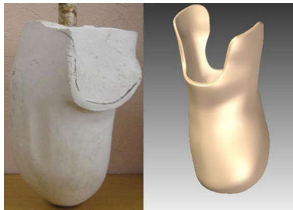
Figura 2. Molde de yeso para el escaneo 3D y modelo CAD 3D del socket .
