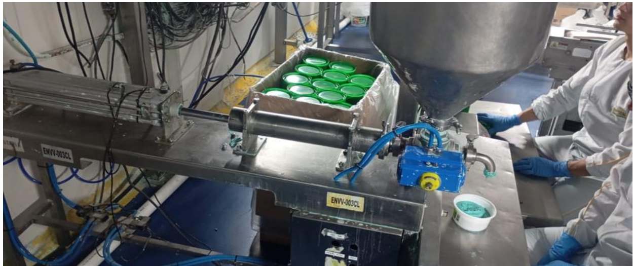
Ilustración 9. Sistema Actual De Llenado De Crema Lava Loza. Elaboración Propia
