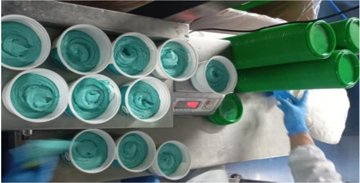
Ilustración 14. Pesaje De Envase. Elaboración Propia
