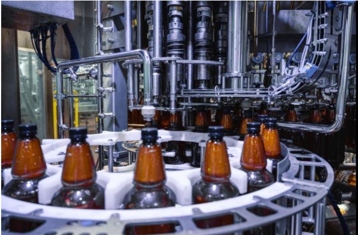
Ilustración 2. Sistema De Llenado En La Industria. Kutz, M. (2018)
