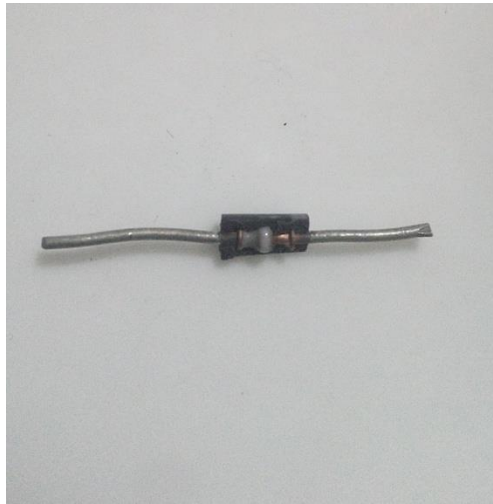
Ilustración 20 Diodo 1n4007 exponiendo núcleo de silicio
