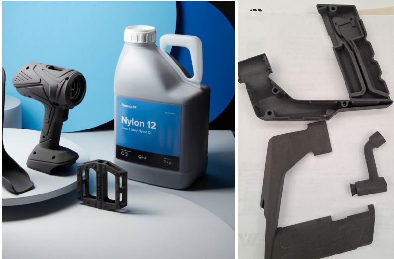
Imagen 31. Fotografía Nylon 12 e impresión 3D en SLS.
