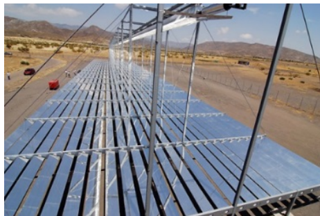
Figura 7. Colectores cilindro parabólicos. [27]. Concentra la radiación entre 30-80 veces. Potencia unitaria de 30 a 80 MW. Temperatura entre 200 y 400 °C.
