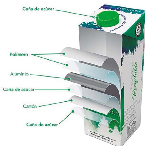
Figura 1. Composición de los empaques Tetra.
