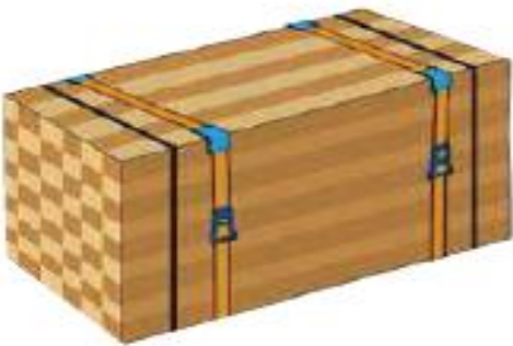
Ilustración 16: Método amarre en una parte o unitarizado
