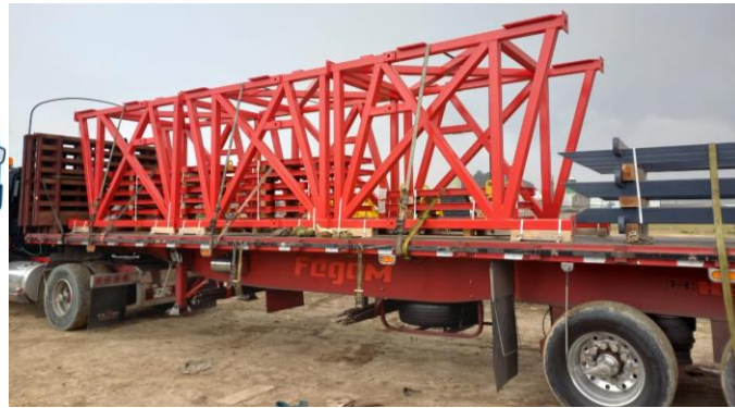
Ilustración 14: método de amarre superior
