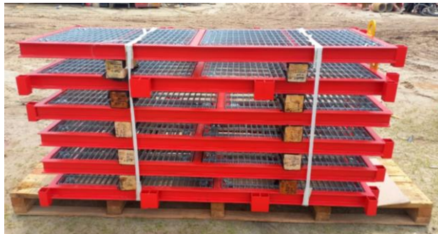
Ilustración 16: Método amarre en una parte o unitarizado
