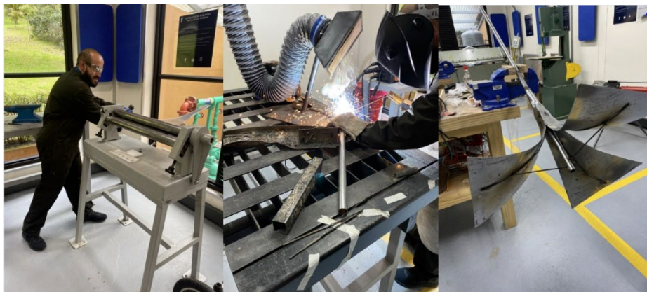
Imagen 68. Procesos de rolado, soldadura y vista inferior de la base. Fuente: El autor
