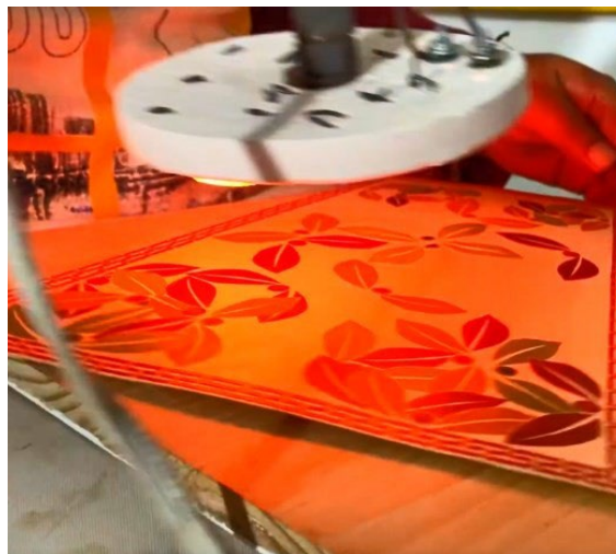
Imagen 60. Proceso de sellado para el Barniz en de las pantallas.
