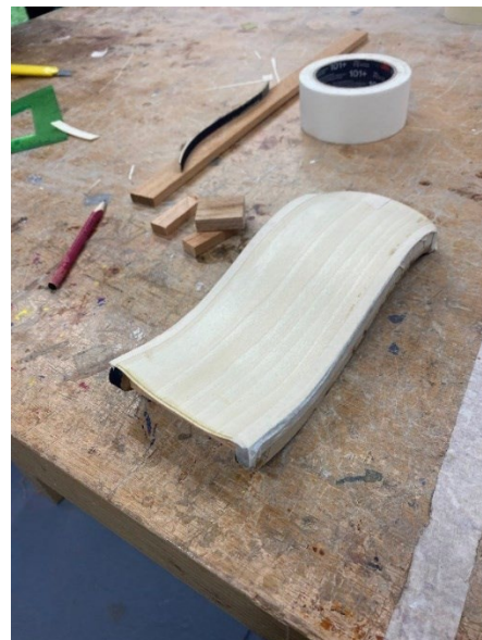
Imagen 29. Curvado de chapilla para los difusores de luz. Fuente: El autor.
