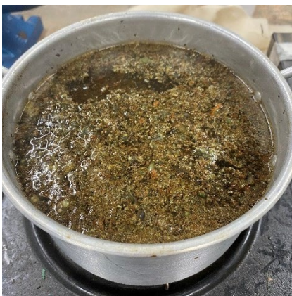
Imagen 6 Proceso de limpieza del mopa-mopa parte 1
