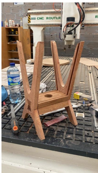
Imagen 76. Ajustes de la lámpara de mesa en el centro de mecanizado CNC Fuente: El autor
