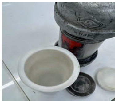
Figura 4. Interior reactor de carbonización hidrotermal
