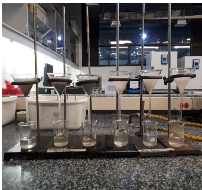
Figura 40 Filtración Fuente: Elaboración propia
