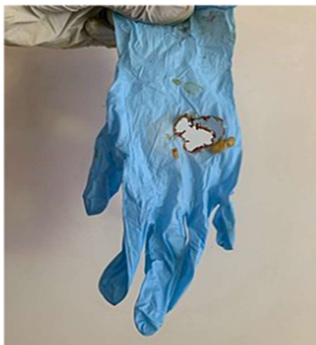
Figura 1. Guante de nitrilo expuesto a gotas de ácido sulfúrico al 98%
