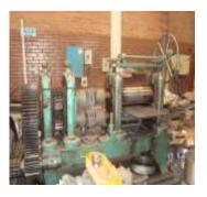
Circuladora de disco: está compuesta por una estructura metálica, la cual permite apoyar el aluminio y así mismo ser cortado en forma circular según se requiera, esta máquina es semiautomática pues requiere que un operario la active y ubique el corte de la misma.
