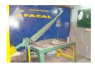
➤ Laminadora: esta compuesta por unos rodillos los cuales presionan la lamina cortada hasta conseguir el grosor deseado, esta máquina es semiautomática pues todo su funcionamiento es realizado por la maquina, aunque el operario debe estar pendiente al momento de que la maquina consiga el grosor especifico para la realización del producto.
