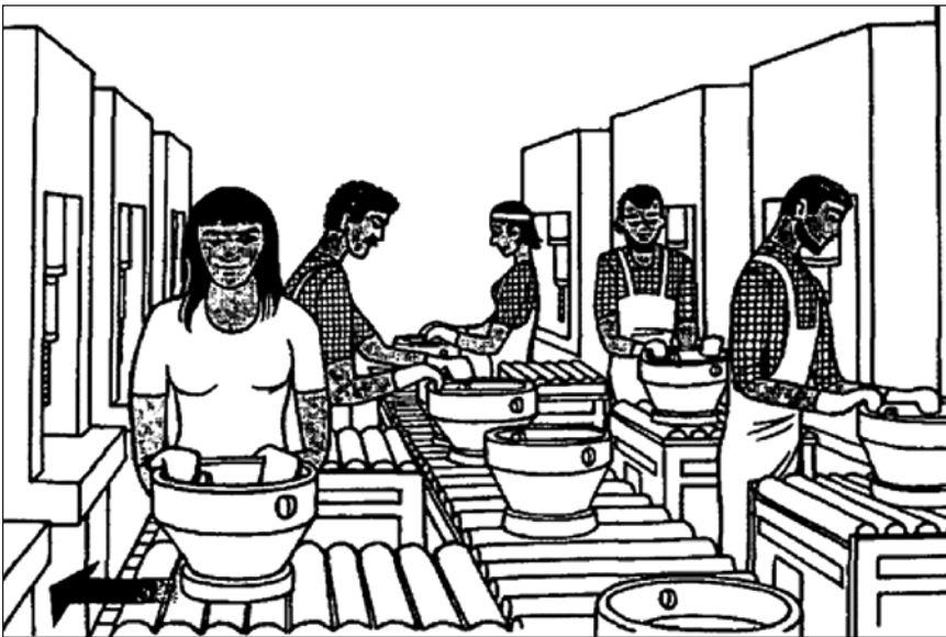
Figura 3. Línea transportadora pasiva para piezas pesadas
