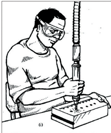
Figura 11. Suspensión de herramientas para reducir el peso
