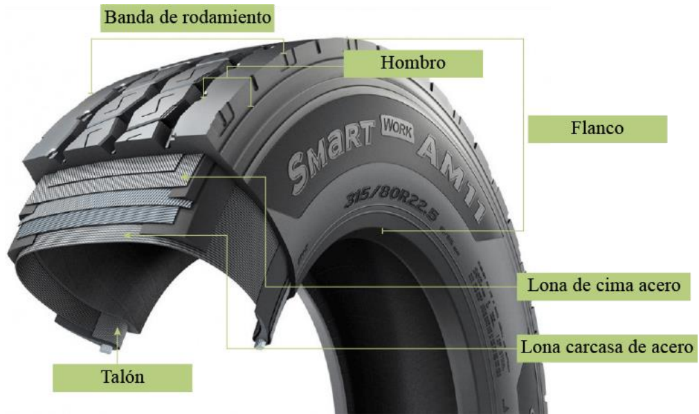
Figura 6: Representación gráfica de las partes de la coraza exterior o llanta. Adaptado de: Flefuel. s.f. Cambio de neumáticos.
