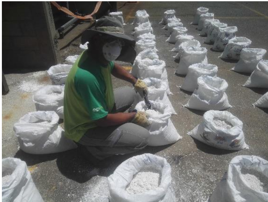
Figura 10. Muestra #1: 45 sacos de las 300 unidades almacenadas en la celda, los cuales fueron organizados en una configuración matricial de 11 \times 4 (+1) y se realizó la apertura de los mismos de forma simultánea. Con un porcentaje de representatividad del 15%.
