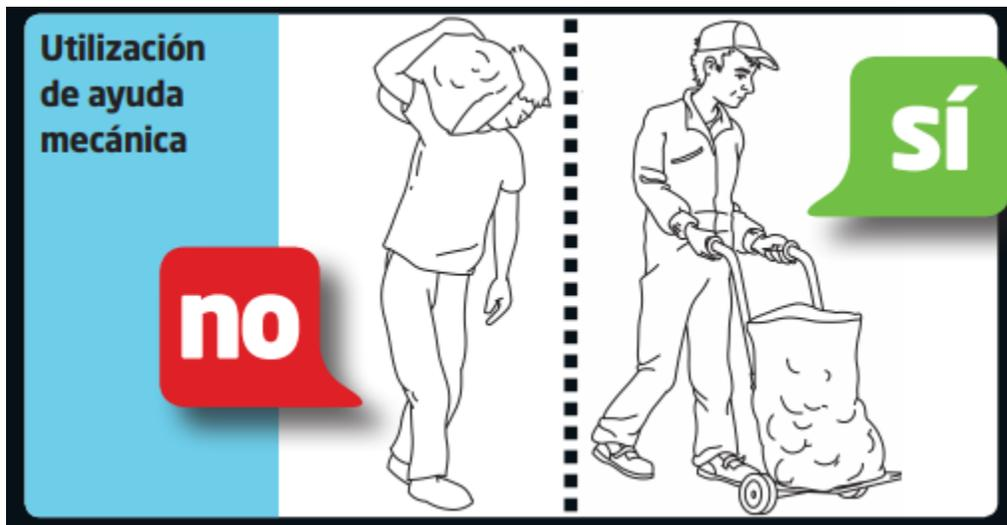
**Figura 1. Utilización de ayudas mecánicas para transporte de carga**
