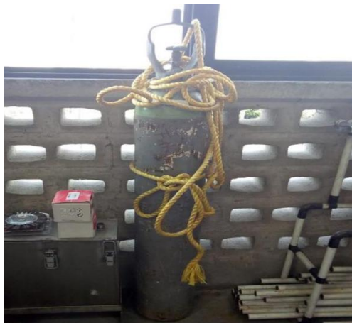
Ilustración 5. Cilindros mal almacenados
