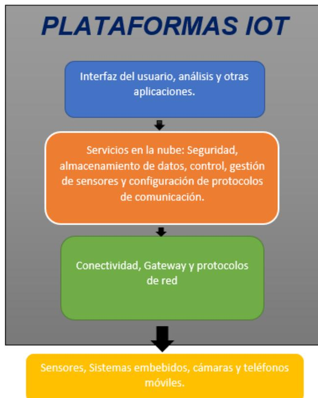
*Figura 1* Plataforma IoT en un sistema de Internet de las cosas. (Elaboración propia)
