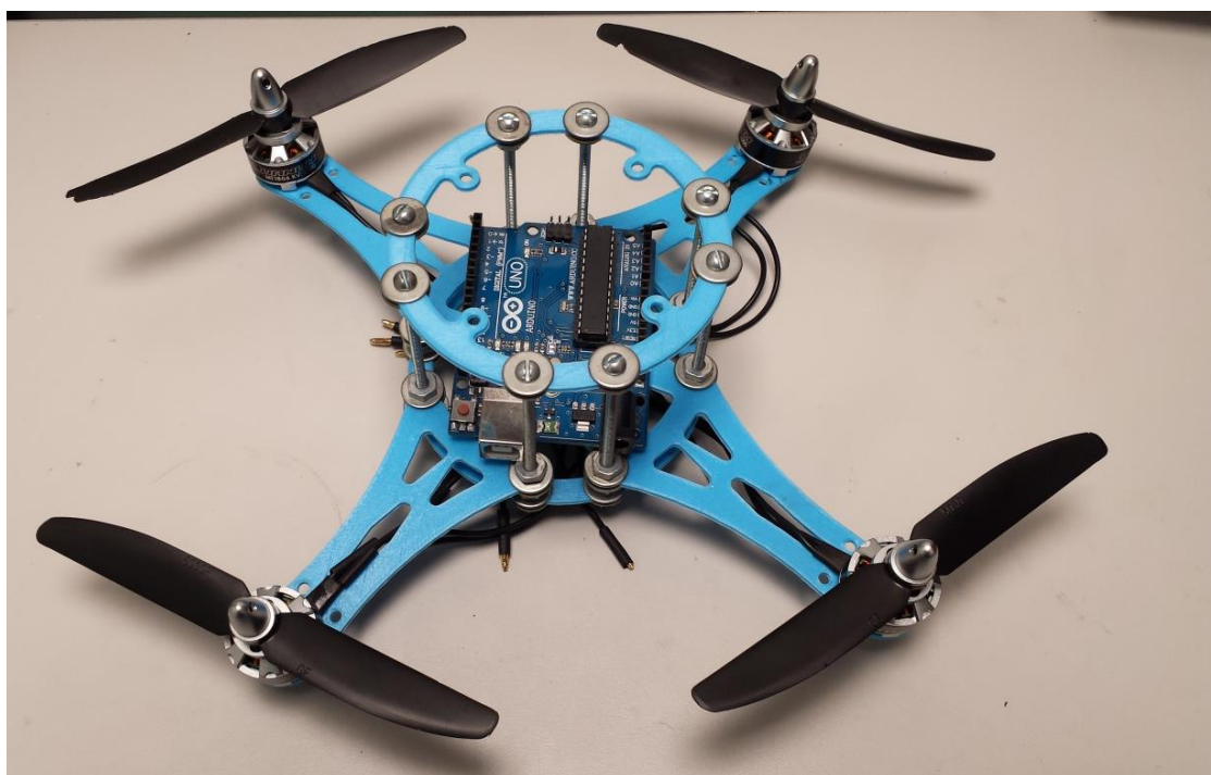
Figura 52. Instalación de Hélices
