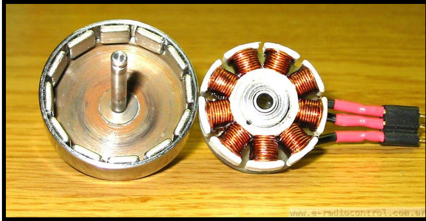
Figura 26. Interior de un Brushless, Rotor, Estator Fuente: (Martínez, Rubio, Baraza, 2014).
