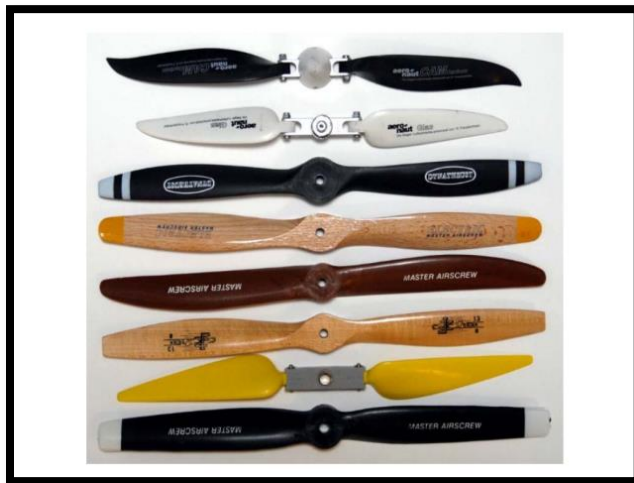
Figura 30. Ejemplos de distintas hélices utilizadas en la fabricación de UAVs Fuente: (Benito, et al, 2015).
