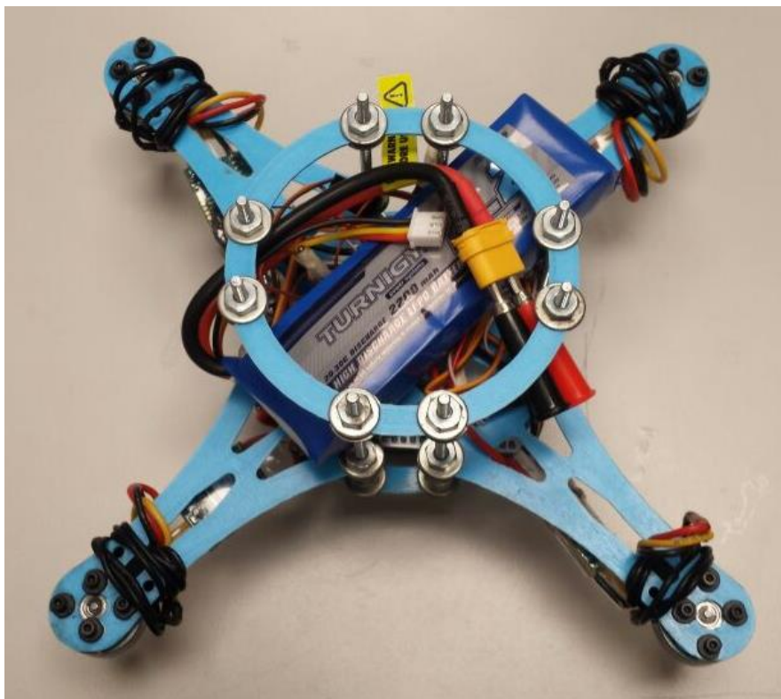
Figura 53. Instalación de batería LIPO 2200 mA H
