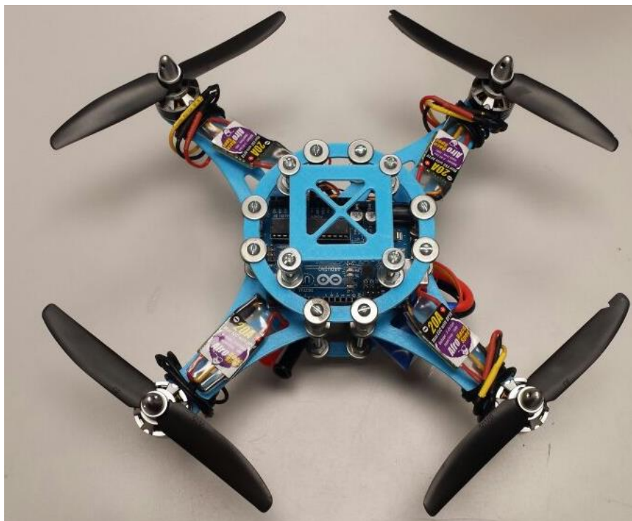
Figura 54. Instalación de ESC, controlador electrónico de velocidad
