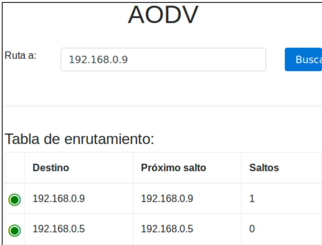
*Figura 25: Descubrimiento de ruta con destino a otro nodo en la red*
