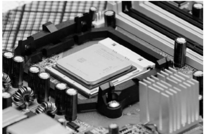
Figura 8 - Izquierda: Una visión genérica del procesador de doble núcleo Intel core-2, con caché local de nivel 1 en la CPU y una caché compartida de nivel 2 en el chip. Derecha: El procesador AMD Athlon 64 X2 3600 CPU de doble núcleo. Fuente: http://en.wikipedia.org/wiki/Multi-core_processor
