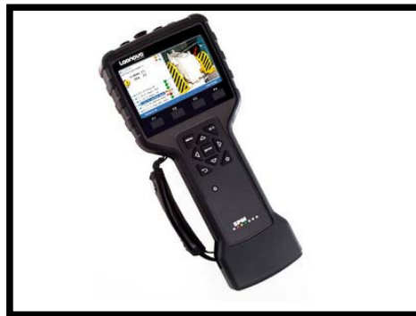
Figura 2 Instrumento lenova para analizar la condición de maquinaria diseñado para ambientes agresivos – año :2017 fuente [3]
