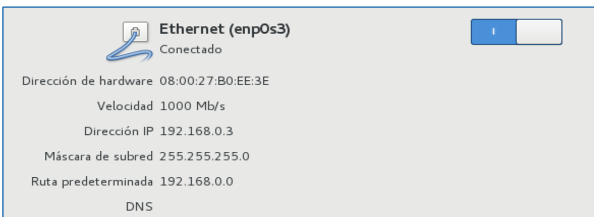
Figura 21 Configuración de red interna MV Hadoop-Slave-0-1 (Fuente: Galeano Cruz y Domínguez Rivera, 2017)
