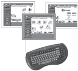
Figura 19. Sistema multifuncional de TV Cable-Interactivo de tv cable s.a. Colombia, en el que un teclado reemplaza a un computador usando el sistema de televisión por suscripción para el acceso a Internet.
