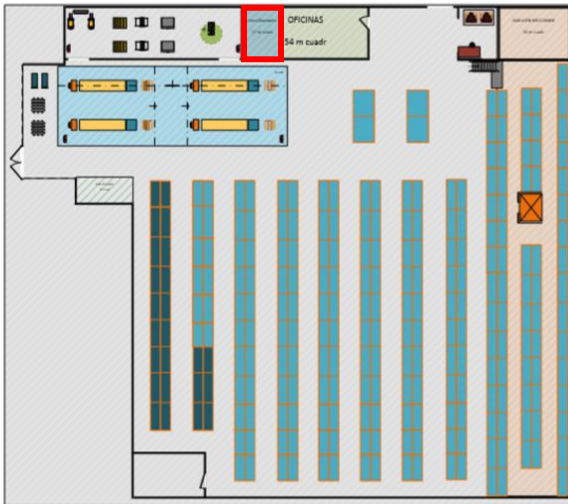
Ilustración 29 Propuesta 2 de LayOut de Centro de Distribución en Girón. Fuente: Elaboración propia
